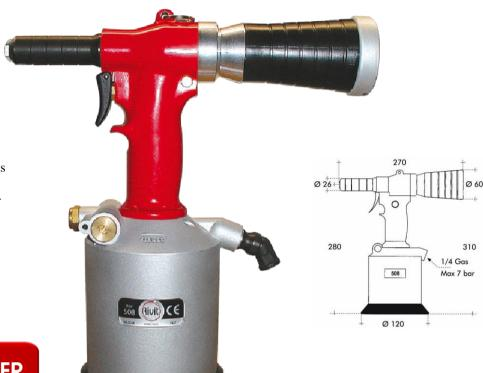
La RIV 508 est idéale pour poser des rivets de structure Rivlok ou Orlock de Ø 6.4 ou Ø 7.8 mm et les boulons à sertir non aveugles de Ø 5 ou Ø 6.4.
